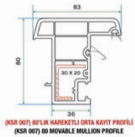
(KSR 007) 80'LIK HAREKETLİ ORTA KAYIT PROFİLİ (KSR 007) 80 MOVABLE MULLION PROFILE
