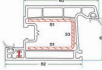
K 6022 BALCON KAPI KANAT PROFİLİ K 6022 BALCONY DOOR SASH PROFILE
