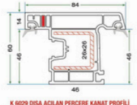
K 6029 DIŞA AÇILAN PERÇERE KANAT PROFİLİ K 6029 OUTWARD OPENING WINDOW SASH PROFILE
