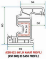
(KSR 003) 80'LIK KANAT PROFİLİ (KSR 003) 80 SASH PROFILE
